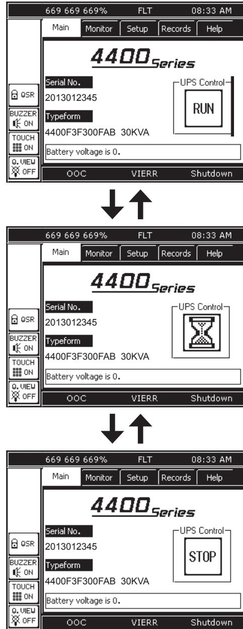
**FIGURE 12.11 – RUN/STOP BUTTON OPERATION**
